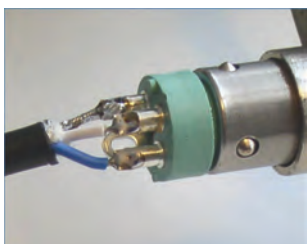
تصویر ۷۶- نقاط اتصال سیستم‌های سیم‌تریک
