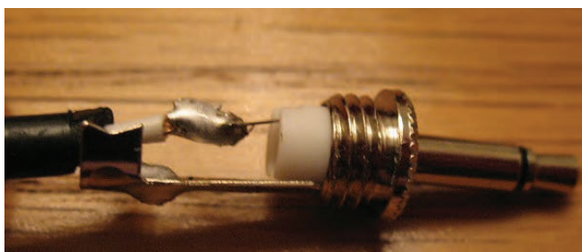
تصویر ۸۵- نقاط اتصال سیستم‌های نان سیمتریک
